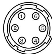
\* 電源接続コネクタ(HR 10A-7R-6P ヒロセ電機)
