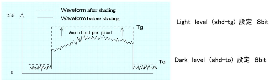
注意: FFC 補正手順は必ず「明レベル内部ゲイン値のクリア」「暗レベル補正」「明レベル補正」の順に行ってください。また明レベル補正を再度行う場合でも暗レベル補正値が入力されていることが条件となります。FFC 補正の補正係数の算出はカメラ内部で複数の画像を必要とします。従って補正の実行は撮像状態で行ってください。外部同期モードの場合はカメラに SYNC 信号を入れる必要が有ります。
