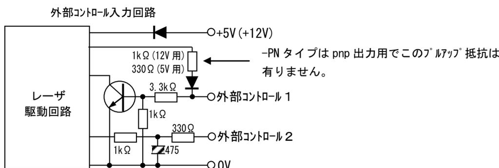
外部コントロール1 はカメラシャッターと同期させたり、高速でレーザを点灯・消灯する場合に使用します。
